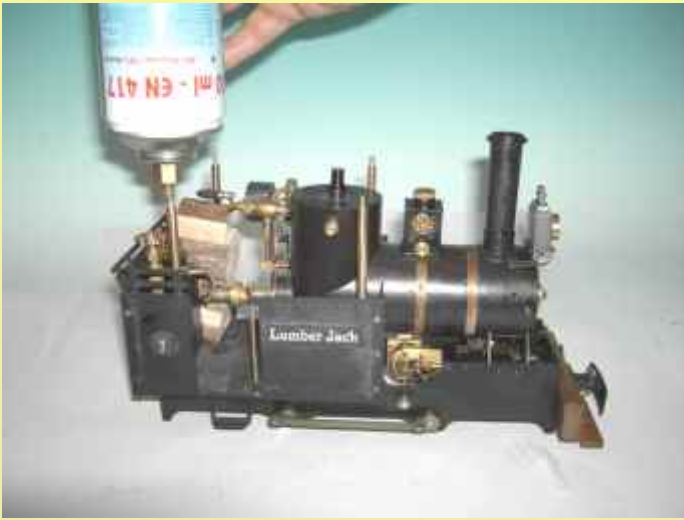
Gaseifüllen mit Einhand- Gasumfülladapter
