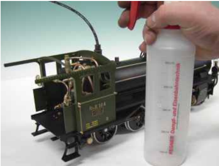
Mit Druckflasche über das Speiseventil einfüllen
